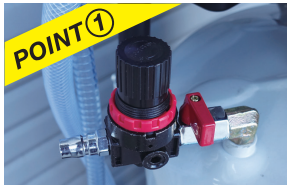
▲ エアー圧を調整する安全装置付
