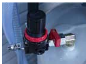
エアー圧を調整する安全装置付
